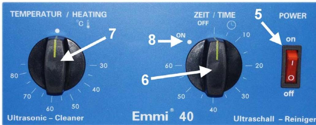
Die Wanne ( 3 ) wird mit Wasser gefüllt und der Netzstecker (4) in die Steckdose gesteckt. Mittels Druck auf den Netzschalter (5) kann jetzt die Reinigungszeit ( 6 ) und die Temperatur ( 7 ) mittels Drehknopf eingestellt werden. Sie können auch auf Dauerbetrieb ( 8 ) ( Linksdrehung ) einstellen. Wir raten jedoch aus Sicherheitsgründen davon ab. Durch Verdunstung kann das Gerät trocken laufen und dabei sich selbst beschädigen.
